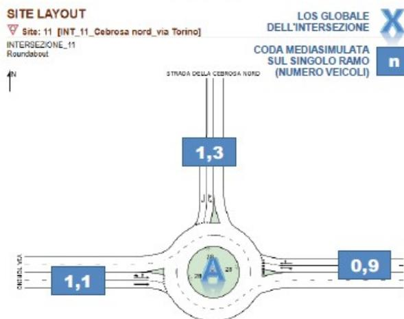
Fig. 3 – intersezione 11: STATO ATTUALE - LOS Globale e lunghezza media simulata delle code
